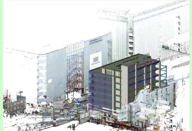
○「3D スキャナー運用事例」 3次元計測 3D スキャナーで RC 躯体制度確認実施事例
